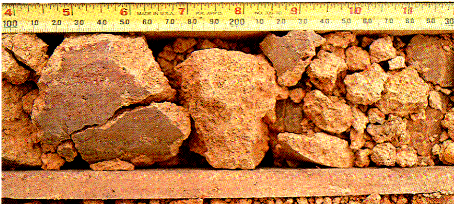
照片圖 2.8 - 全風化火山岩 ( V 級 ) , 細部 B
