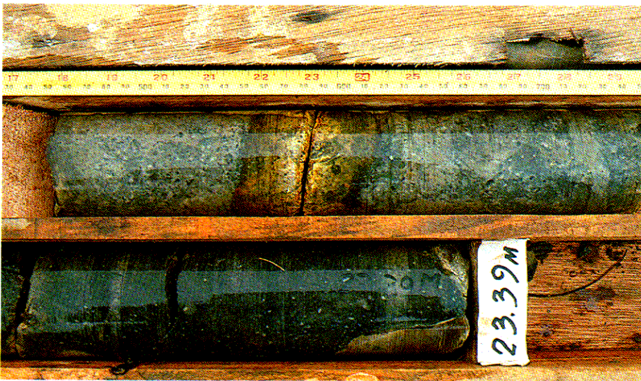
照片圖 2.14 - 微風化花崗岩 (II 級) 中的中度風化夾層 (III 級) : 細部 H
