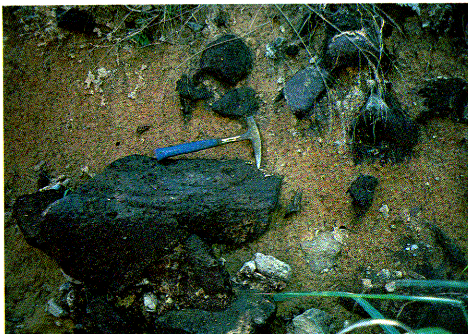
照片圖 1.14 - 無結構性土基質中具有漂石的火山岩質坡積物
