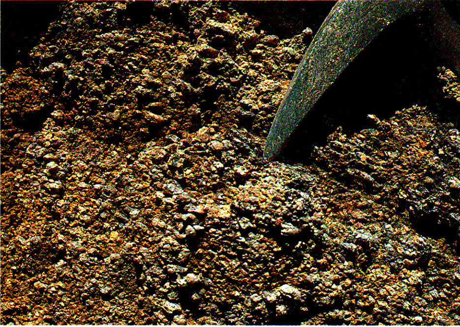
照片圖 1.1 - A 帶中的花崗岩殘積土
