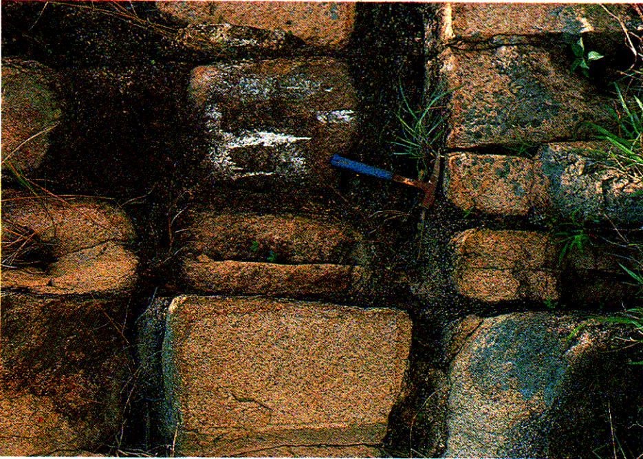
照片圖 1.7 - 沿節理強烈風化的花崗岩：C 帶
