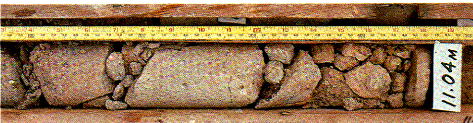
照片圖 2.11 - 中度風化火山岩 ( III 級) : 細部 E
