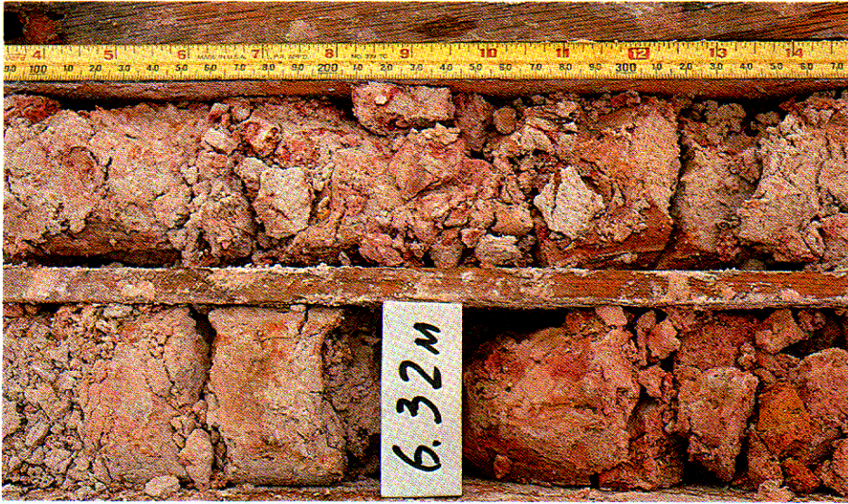
照片圖 2.9 - 全風化火山岩 ( V 級) : 細部 C
