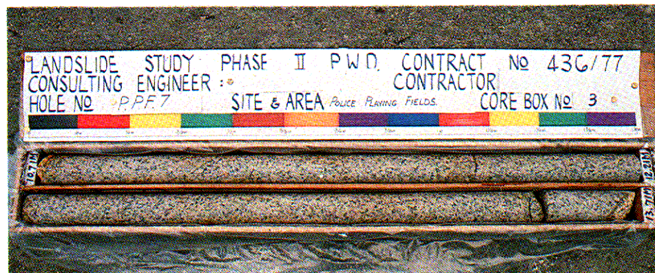
照片圖 2.17 - 微風化花崗岩 (II 級) , 10.71 - 13.71 m
