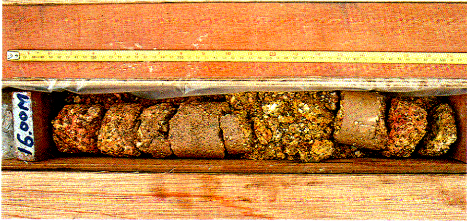
照片圖 2.24 - 強風化花崗岩（IV 級）：細部 C
