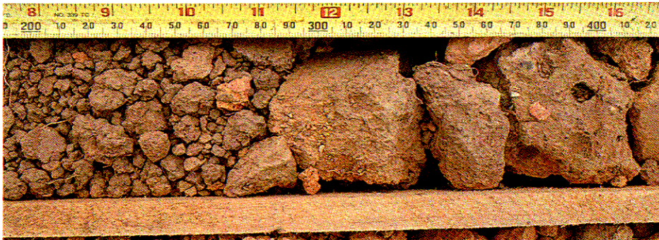
照片圖 2.7 - 火山岩質殘積土 ( VI 級 ) , 細部 A
