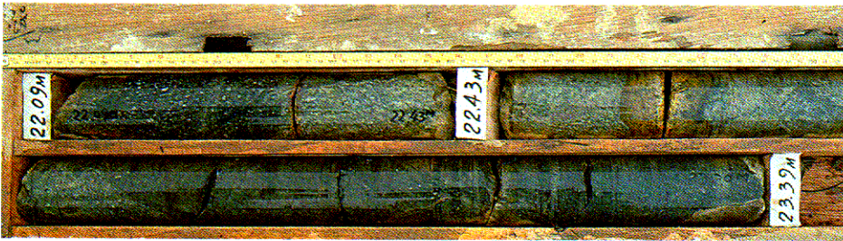
照片圖 2.13 - 微風化火山岩 (II 級) : 細部 G
