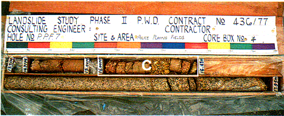
照片圖 2.18 - 強風化花崗岩 (IV 級), 13.71 - 16.45 m 中度風化花崗岩 (III 級), 16.45 - 17.95 m
