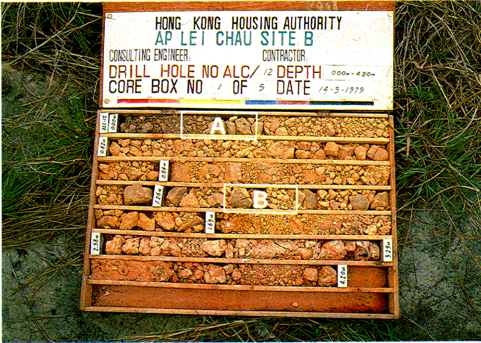
照片圖 2.2 - 火山岩質殘積土 (VI 級), 0 - 0.24 m 全風化火山岩 (V 級), 0.24 - 4.20 m
