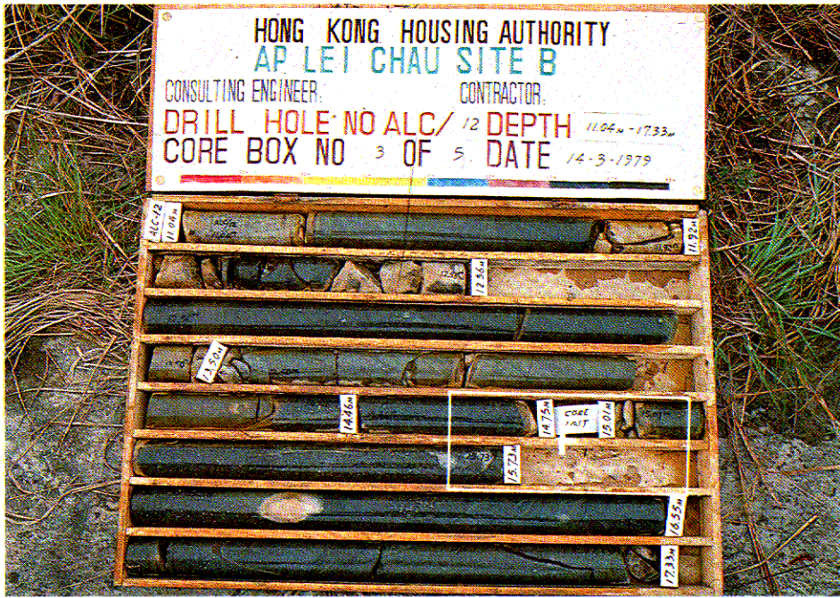
照片圖 2.4 - 微風化火山岩 (II 級), 11.04 - 17.33 m
