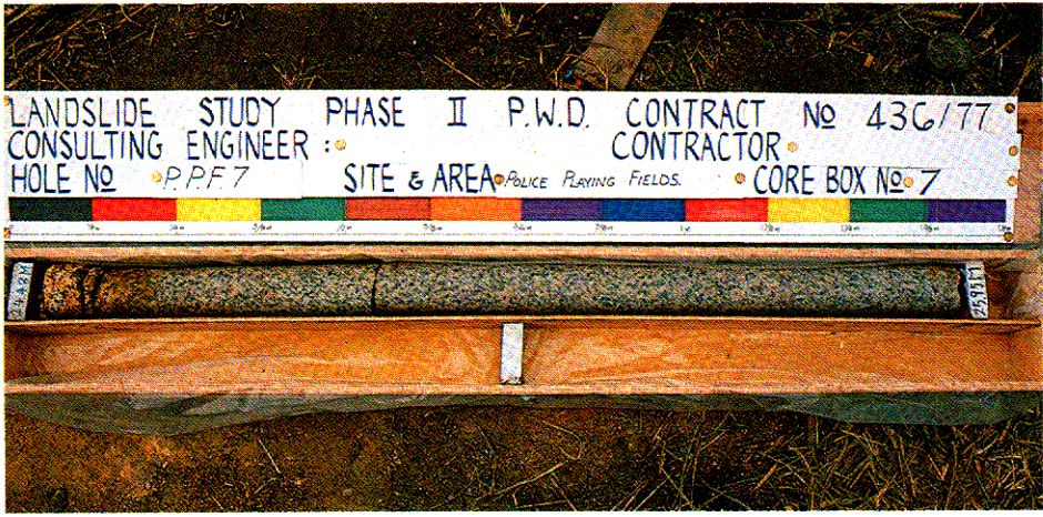
照片圖 2.21 - 微風化花崗岩（II級），24.28 - 25.95 m
