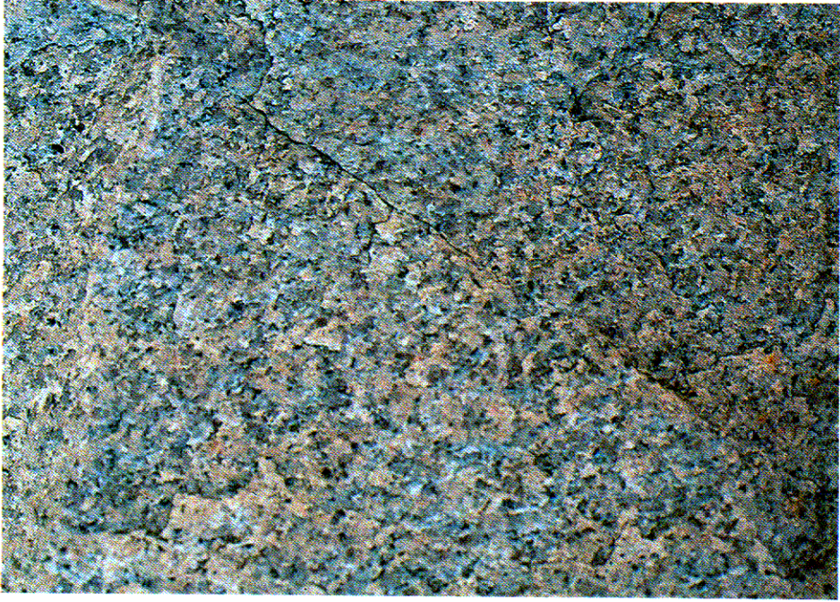
照片圖 1.11 - D 帶中的新鮮花崗岩
