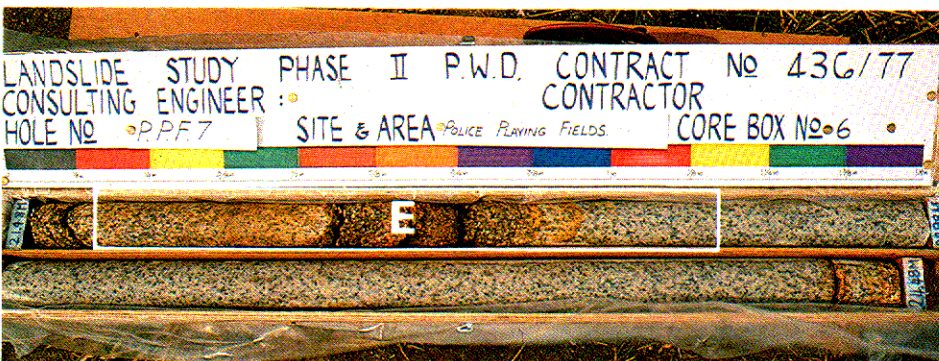
照片圖 2.20 - 中度風化花崗岩 (III 級), 21.48 - 22.00 m 微風化花崗岩 (II 級), 22.00 - 24.48 m
