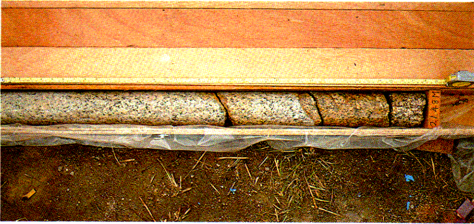
照片圖 2.25 - 微風化花崗岩（II 級）變至中度風化花崗岩（III 級）：細部 D
