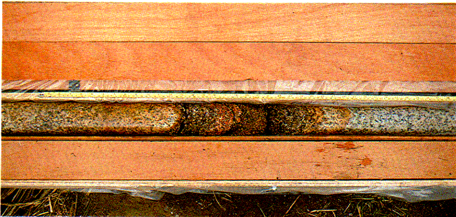
照片圖 2.26 - 微風化花崗岩（II 級）中的強風化夾層（IV 級）：細部 E
