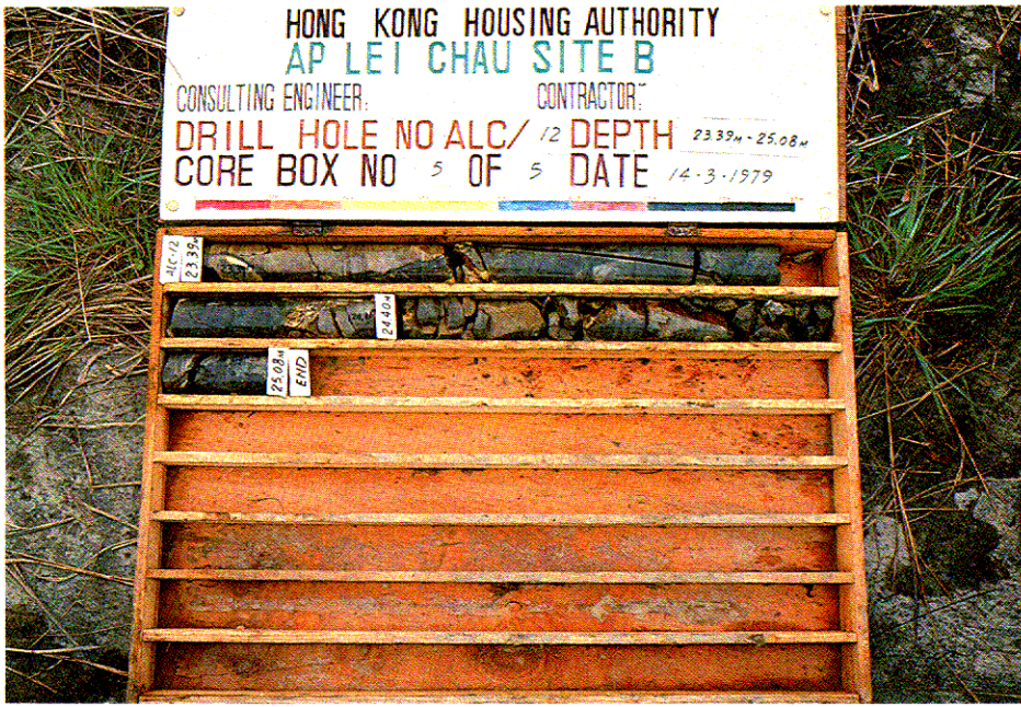
照片圖 2.6 - 微風化火山岩 (II 級), 23.39 - 25.08 m
