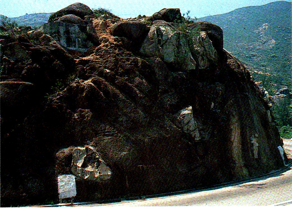
照片圖 1.5 - 具有殘留節埋及孤石的風化花崗岩典型 B 帶露頭：A 帶缺失
