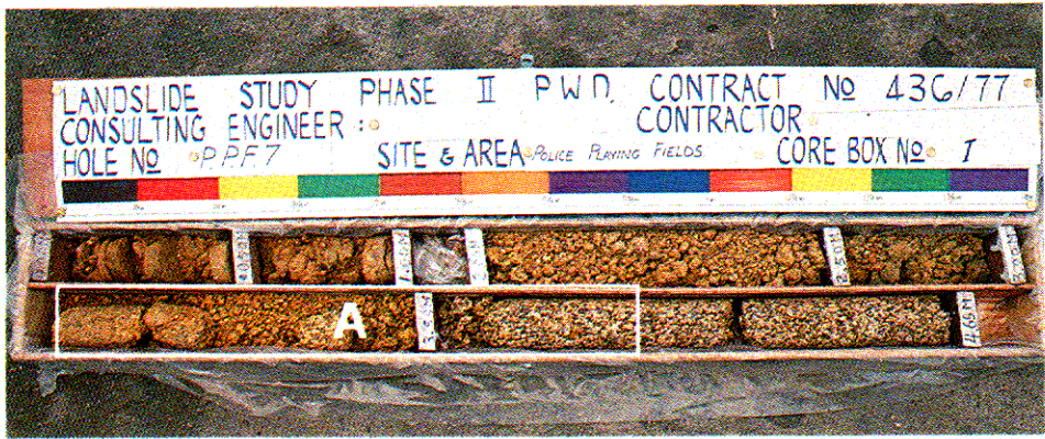
照片圖 2.15 - 全風化花崗岩 (V 級), 0 - 1.00 m 強風化花崗岩 (IV 級), 1.00 - 3.59 m 中度風化花崗岩 (III 級), 3.59 - 4.65 m
