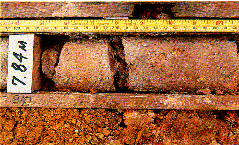
照片圖 2.10 - 具有銹跡不連續面的全風化火山岩 ( V 級) : 細部 D
