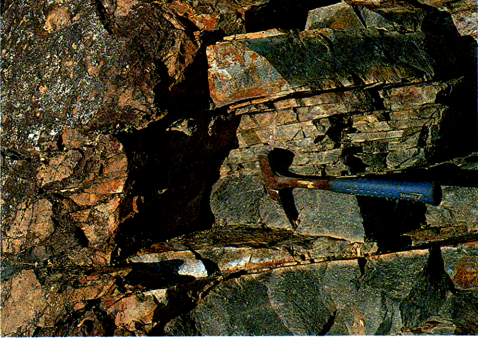
照片圖 1.10 - 沿節理面有銹跡的火山岩：D 帶
