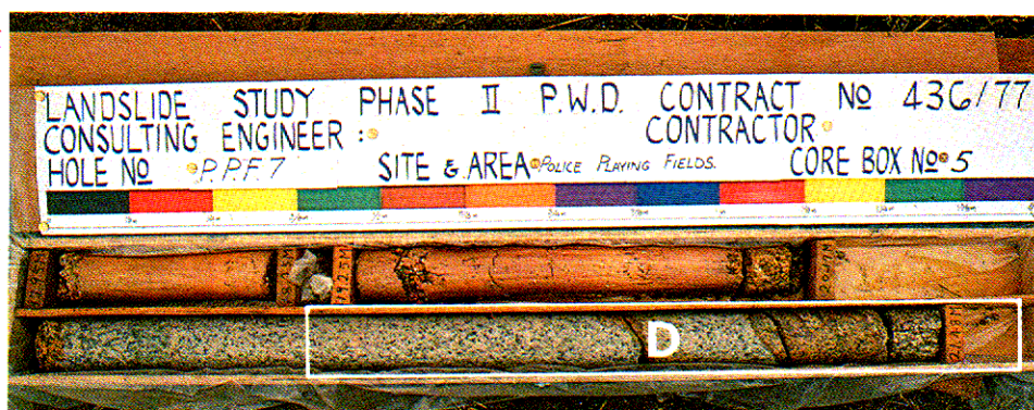
照片圖 2.19 - 強風化花崗岩 (IV 級), 17.95 - 20.17 m 微風化花崗岩 (II 級), 20.17 - 21.23 m 中度風化花崗岩 (III 級), 21.23 - 21.48 m
