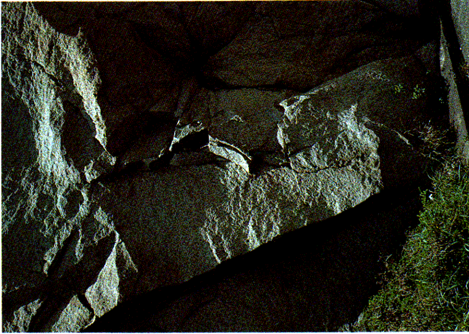
照片圖 1.9 - 節理上有輕微銹跡的花崗岩：中右部可見到 爆破遺留的裂隙：D 帶
