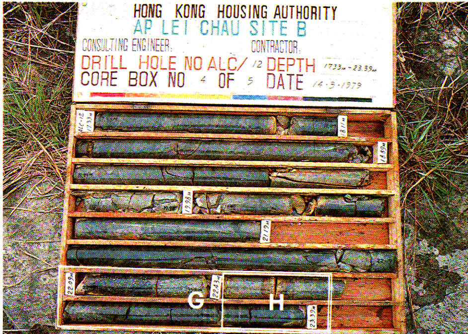
照片圖 2.5 - 微風化火山岩 (II 級), 17.33 - 23.39 m
