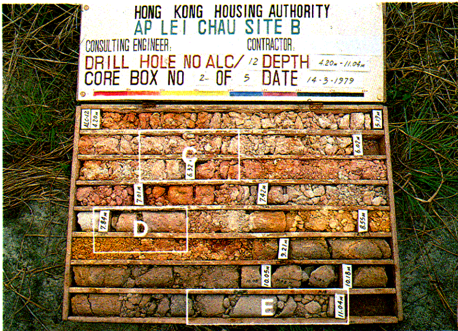
照片圖 2.3 - 全風化火山岩 (V 級), 4.20 - 9.21 m 強風化火山岩 (IV 級), 9.21 - 10.05 m 中度風化火山岩 (III 級), 10.05 - 11.04 m
