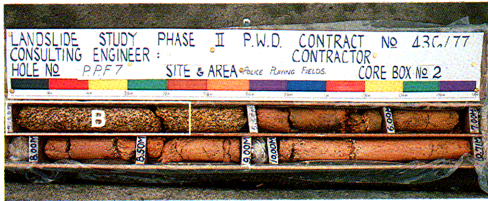
照片圖 2.16 - 中度風化花崗岩 (III 級), 4.65 - 5.55 m 強風化花崗岩 (IV 級), 5.55 - 10.71 m
