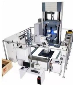
自動鋼筋拉力測試系統
