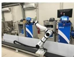
自動混凝土磚測試系統
