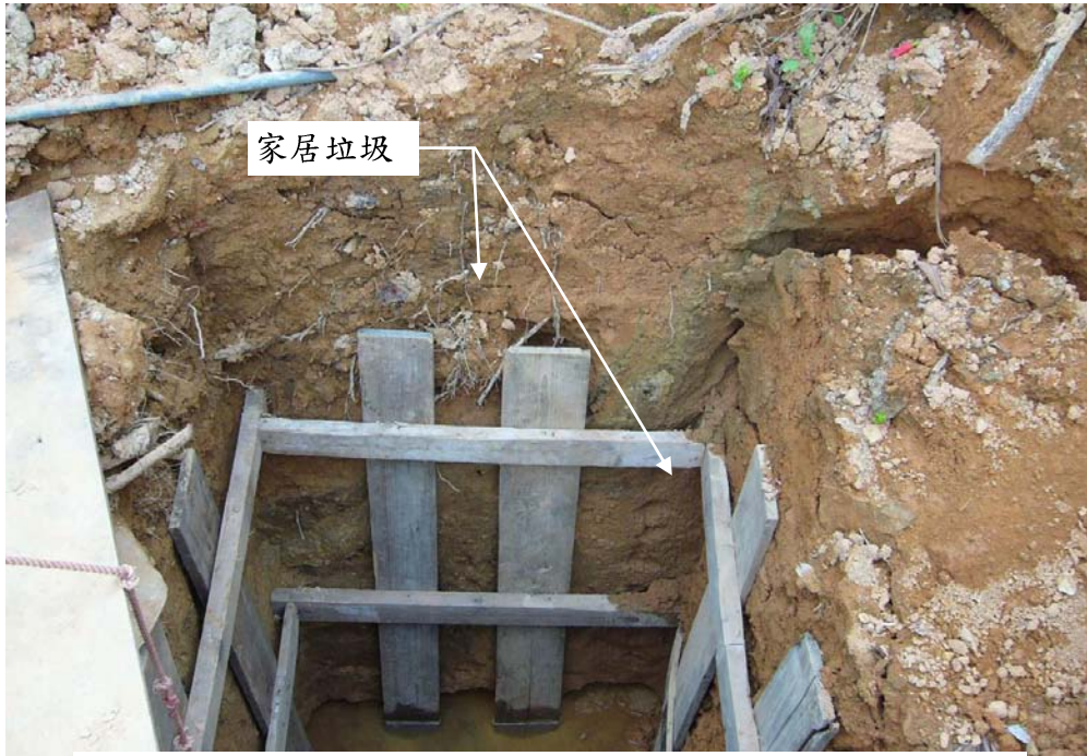
照片 20 - 探井 TP4 顯示滑坡泥石含有已變形的家居垃圾層 (照片攝於二零零五年十月十七日)
