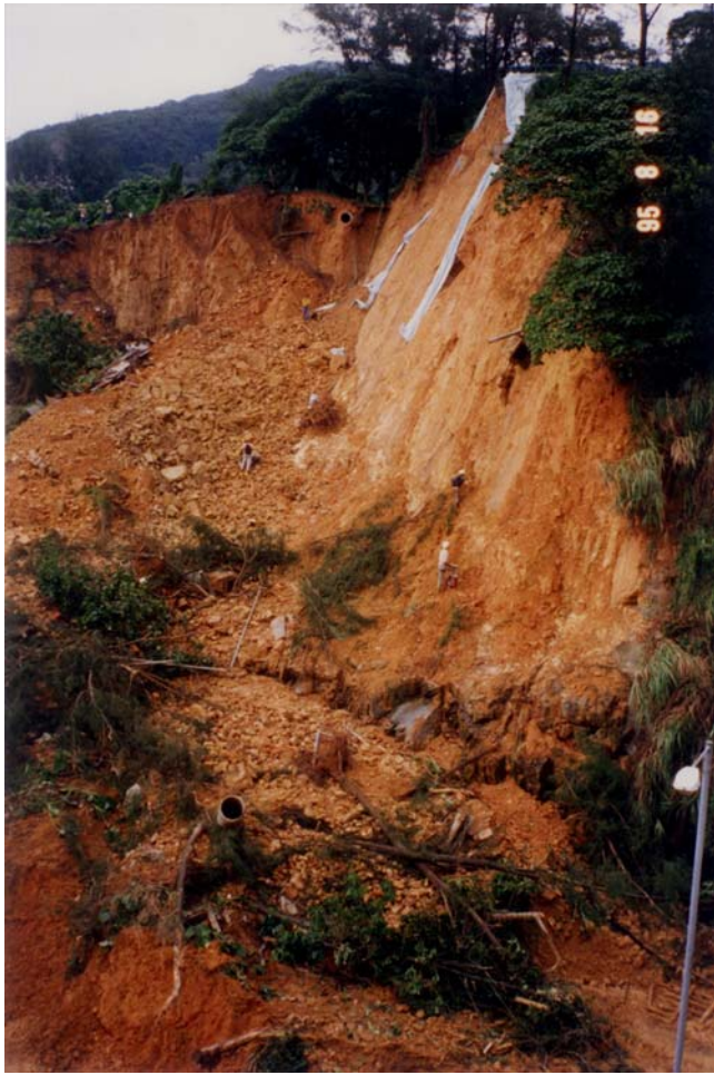
照片8 - 形成山泥傾瀉滑坡崖 的風化岩石節理 (一九九五年八月十九日 拍攝。其位置見圖21)
