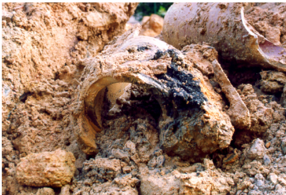
照片M10 - 從山泥傾瀉塌下的泥石中尋回的污水管折斷部份，渠管附著含有黑色污漬的泥土。(照片攝於一九九四年七月二十七日)
