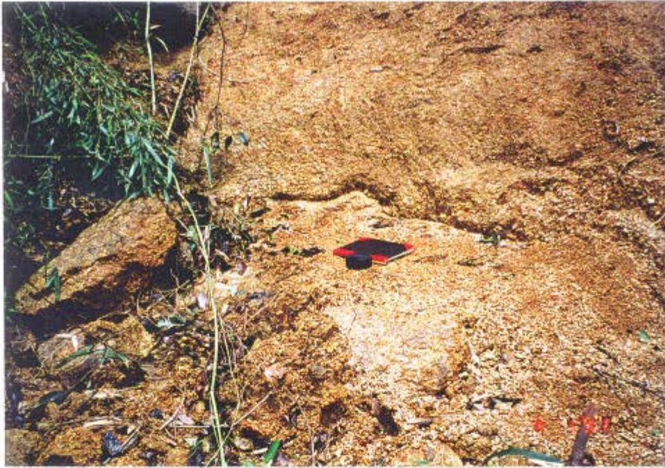
照片6 - 在侵蝕沖溝裏外露的節理，傾角為30度，形成破裂面的下部 (一九九七年八月四日拍攝，其位置見圖14 )
