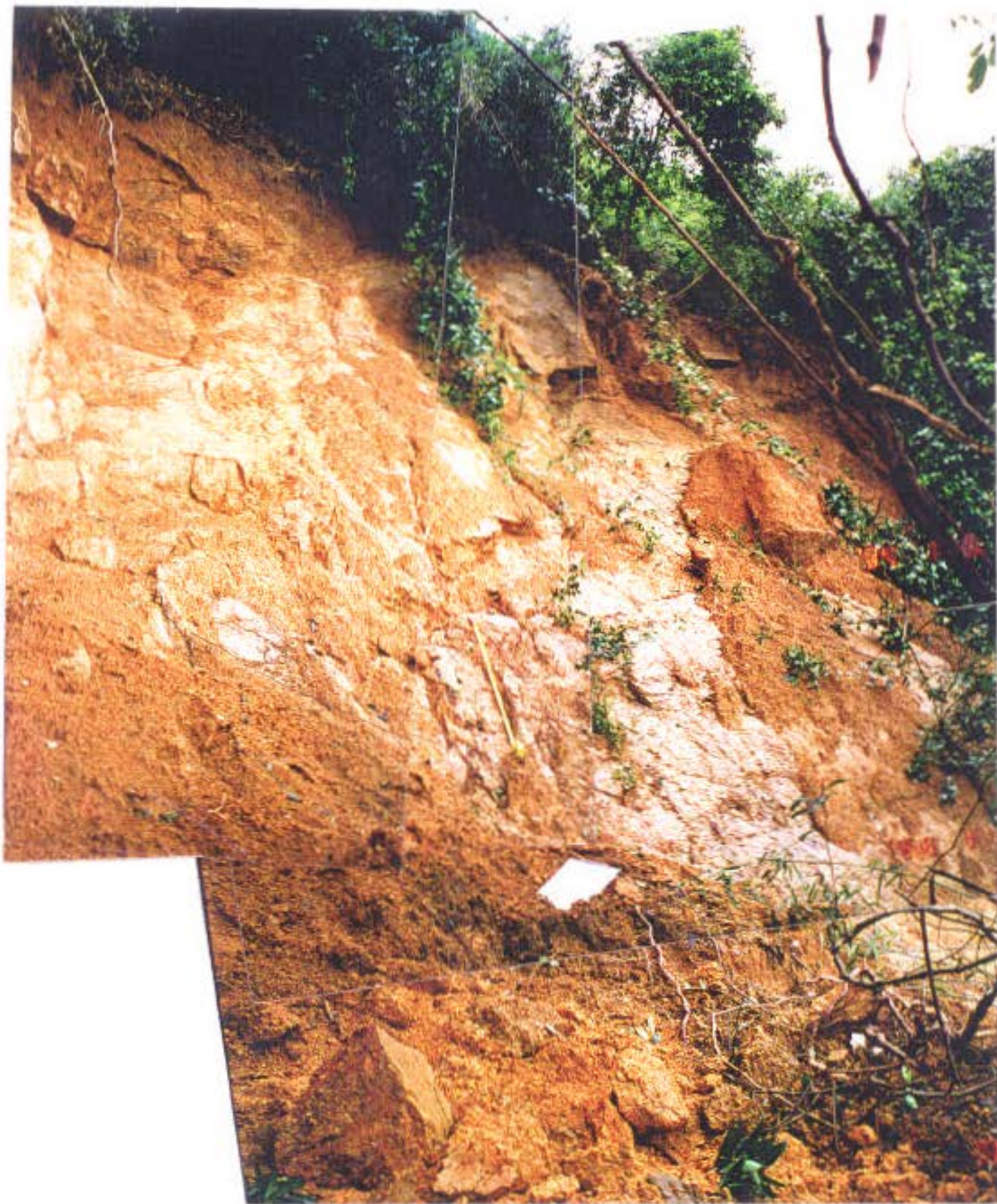
照片5 - 主滑坡崖上部的景象，顯示部分風化花崗岩帶 (0-30%岩石至殘積土)及面狀節理面 (一九九七年七月七日拍攝，比例為1米的 卷尺，其位置見圖14)
