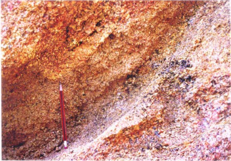
照片8 - 沿著山泥傾瀉破裂面的下部的棕色軟黏土質砂 (一九九七年十一月十二日拍攝，注意棕色的黏 土層的厚度與鉛筆長度相同，其位置見圖14 )
