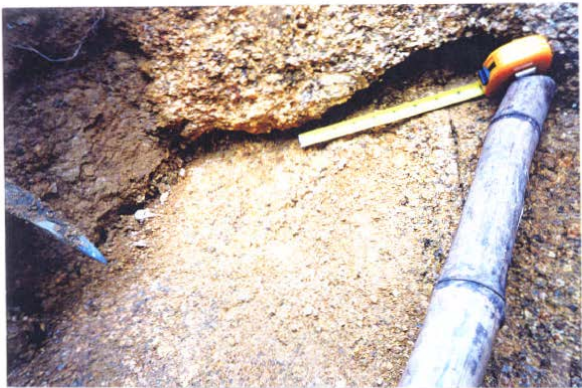
照片9 - 在主崩塌崖東北角的侵蝕管的景象(一九九七年 九月二十三日拍攝，其位置見圖14 )
