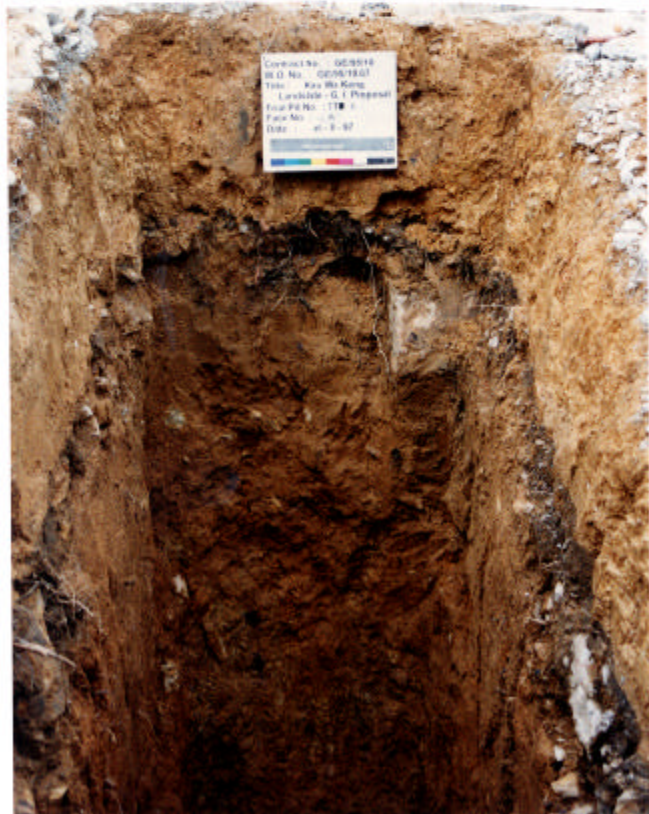
照片11 - 平台上，山泥傾瀉的泥石覆蓋在很薄的土層和填土之上（其位置見圖14）
