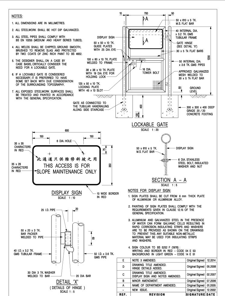
LOCKABLE GATE FOR MAINTENANCE STAIRWAY ON SLOPES UP TO 40°
