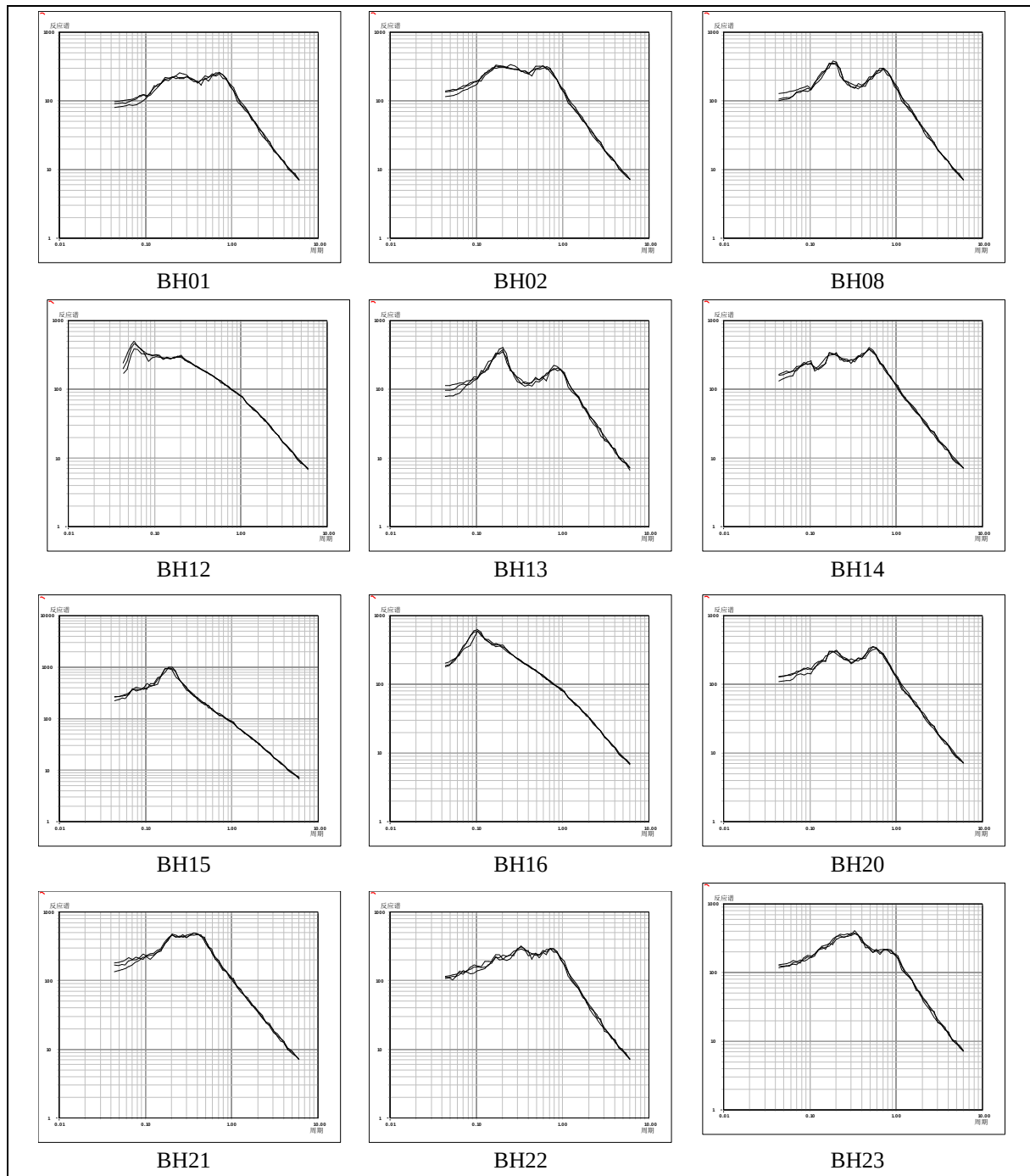
圖 7.1c 各鑽孔地表水平向地震動加速度反應譜及標定地震動反應譜 (50 年 10%) (第 1 頁共 2 頁)
