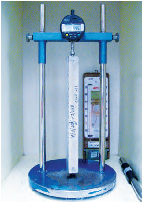
檢定驗 — 骨材反應潛能的水泥砂漿棒超快速試驗 (CS1:2010)
