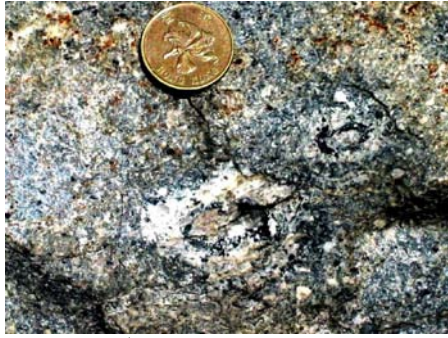
碎斑熔岩中外來岩塊被熔蝕，其成份因重新分配形成的環狀構造
